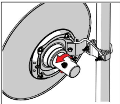
Presione el pestillo de bloqueo hacia atrás y manténgalo presionado para liberar el adaptador.
